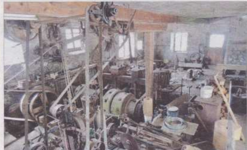
Unzählige Riemen, Stäbe und Räder machten den Antrieb der alten Bohrmaschinen und Sägen, Hämmer und Bälge durch die Wasserräder möglich.
