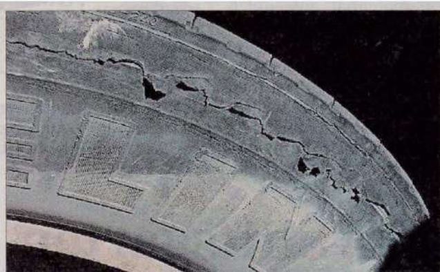
Bei einem Reifen löste sich die Lauffläche. Foto: Polizei Füssen
