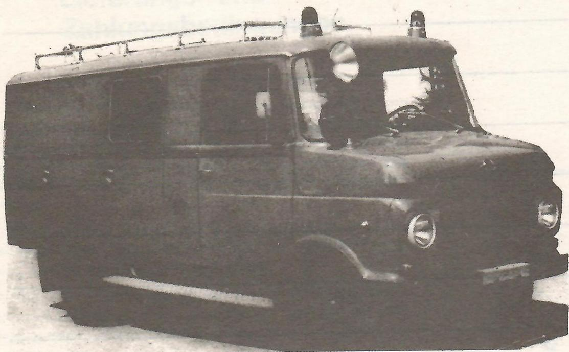
Mit 80 PS 6-Zylinder-Benzinmotor, 3000 mm Radstand, M & S - Bereifung. Kompletter feuerwehertechnischer Aufbau und Ausstattung nach den Bauvorschriften des Österr. Bundes-Feuerweherverbandes.
