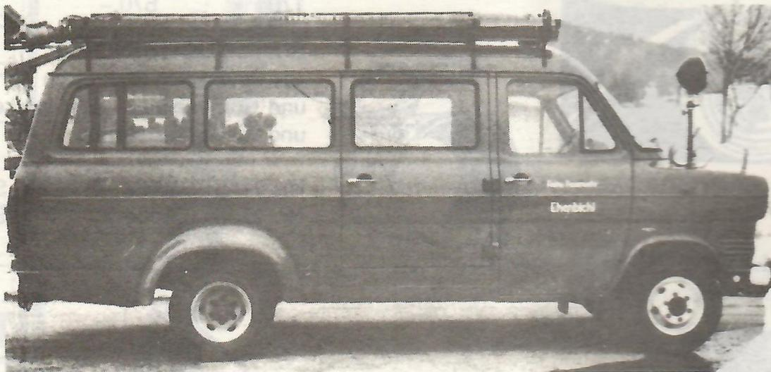
Mit 75-PS, 4 Zylinder-Benzinmotor, Zwilling-Antriebsräder, M & S-Bereifung. Kompletter feuerwehrtechnischer Aufbau und Ausstattung nach den Baurichtlinien des Österr. Bundesfeuerwehrverbandes.
