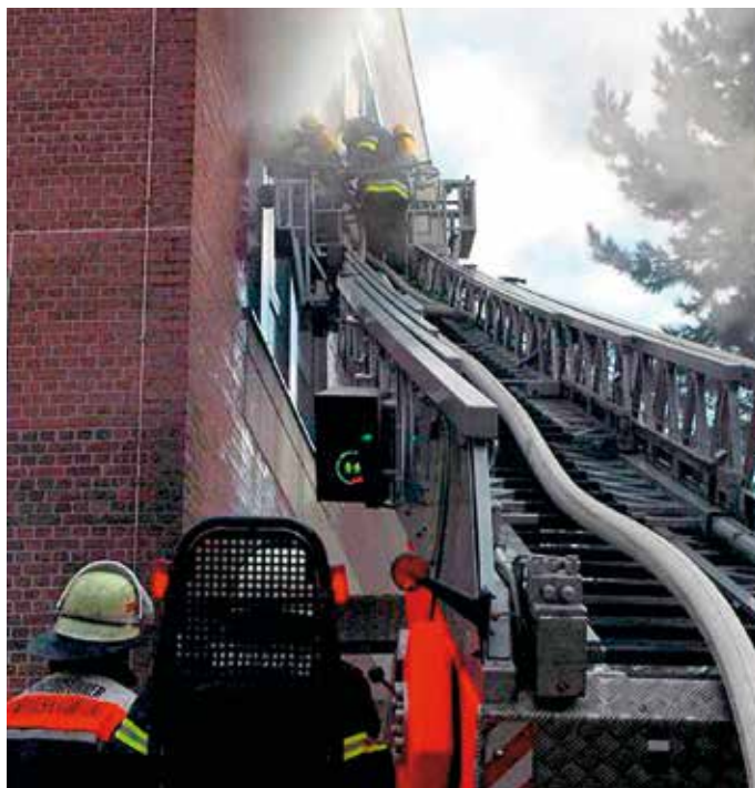
Im Rahmen der Brandbekämpfung kann über eine Drehleiter ein alternativer Angriffsweg sichergestellt werden.
