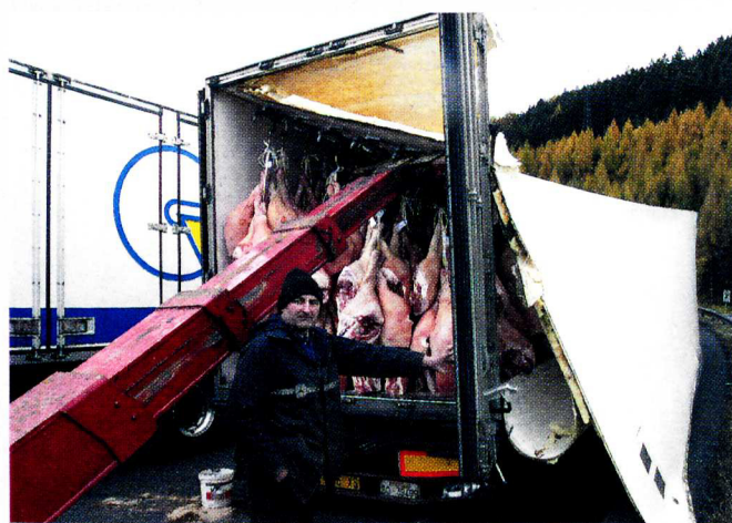
Die Seitenwand des Transporters brach in einer Kehre auf
