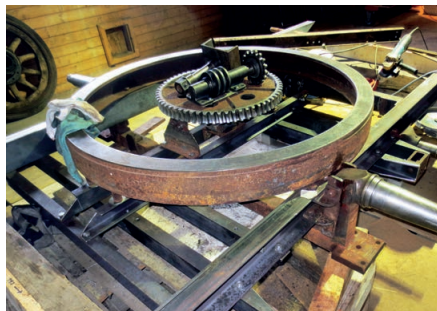
Ein kompliziertes Werk! Der Drehkranz des Leiterparks erfordert viel Fachkenntnis.
