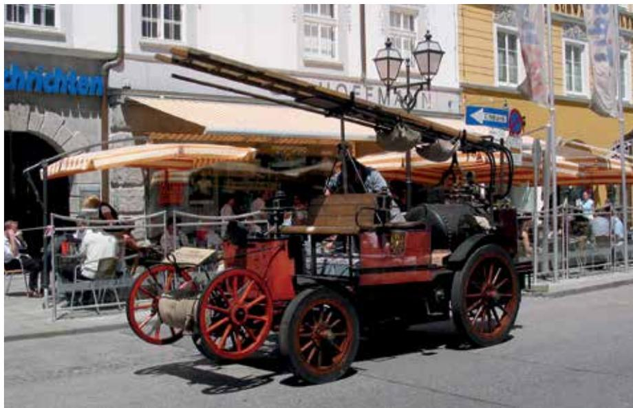
Elektrisch angetriebenes Fahrzeug der Berufsfeuerwehr Wien.
