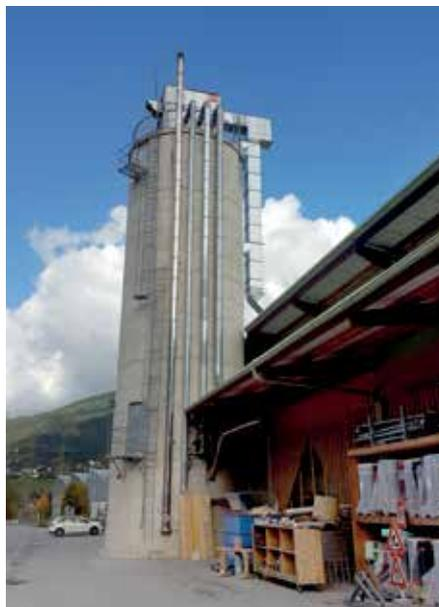
**Prävention gegen Staubbrand:** Silo mit aufgesetzter Entstaubungsanlage
