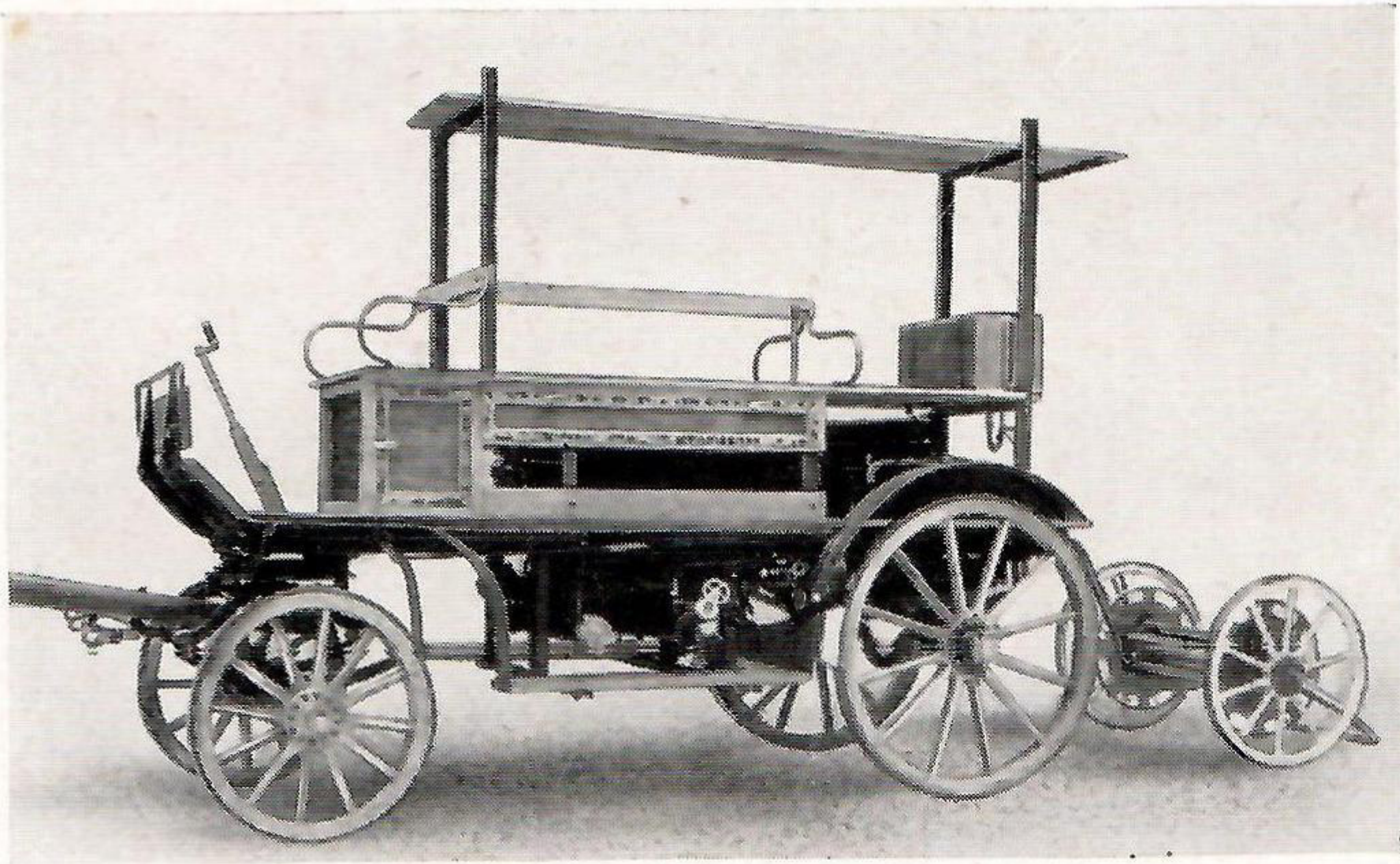
Bild 28 Vierrad-Motorspritze mit Kreiselpumpe, 1912
