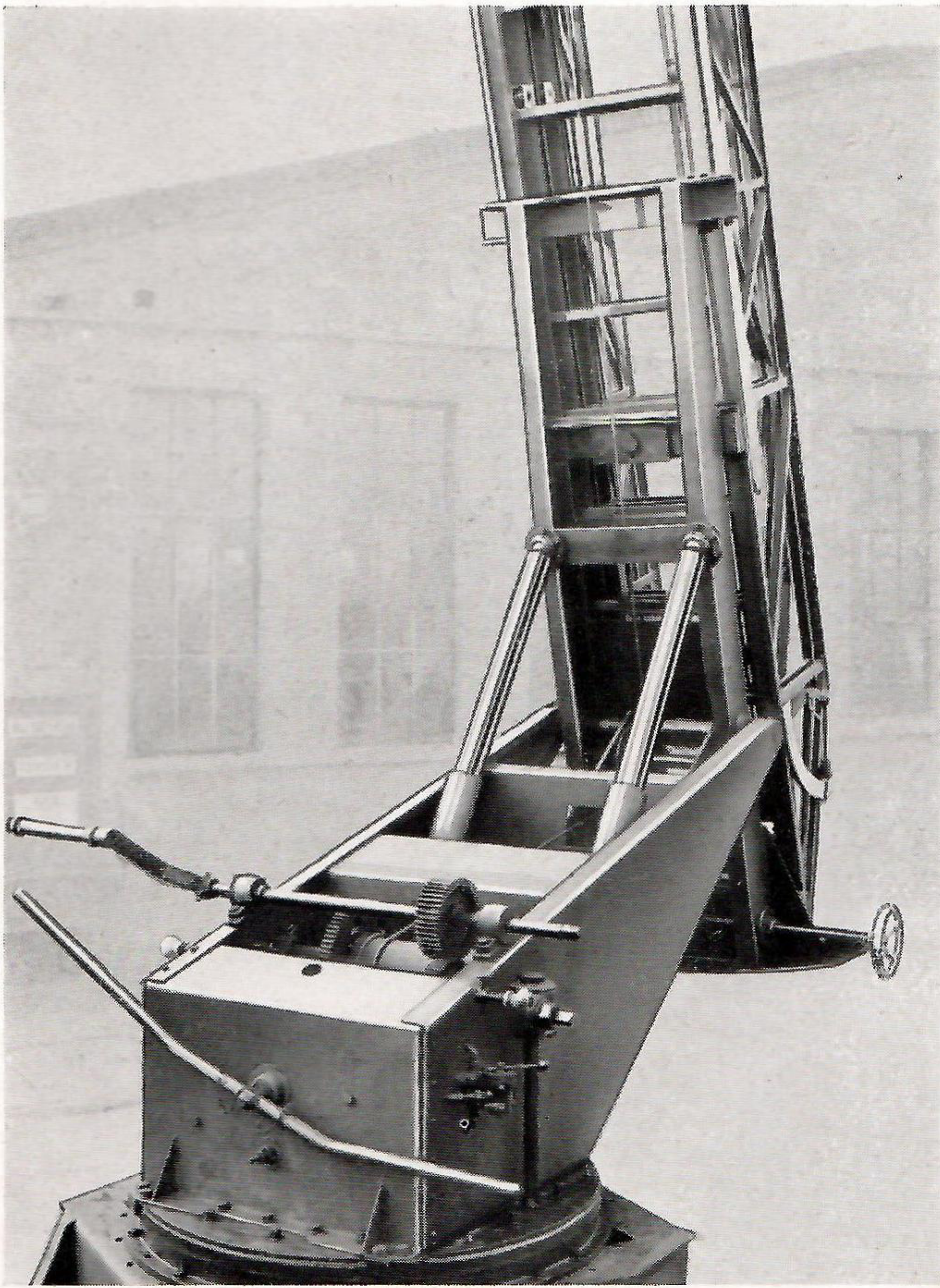
Bild 81 Kraftfahrdrehleiter mit hydraulischer Aufrichtung
