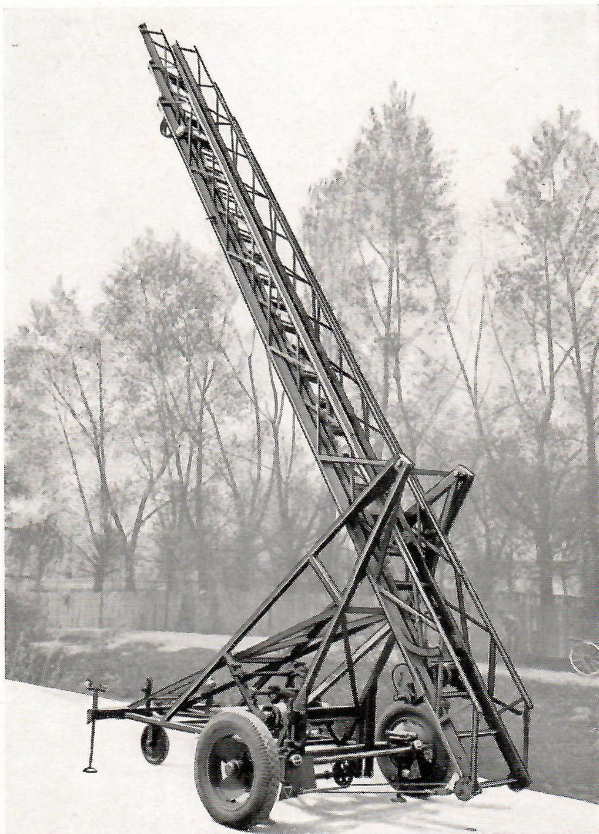
Bild 73 Anhängeleiter, Bauart ALS 18, 18 m Steighöhe
