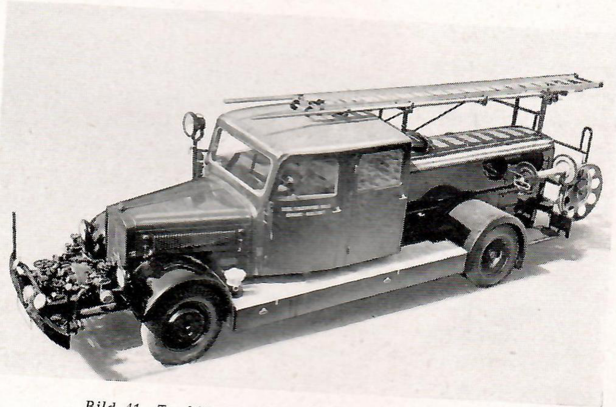
Bild 41 Tanklöschfahrzeug mit Vorbaupumpe, 1939
