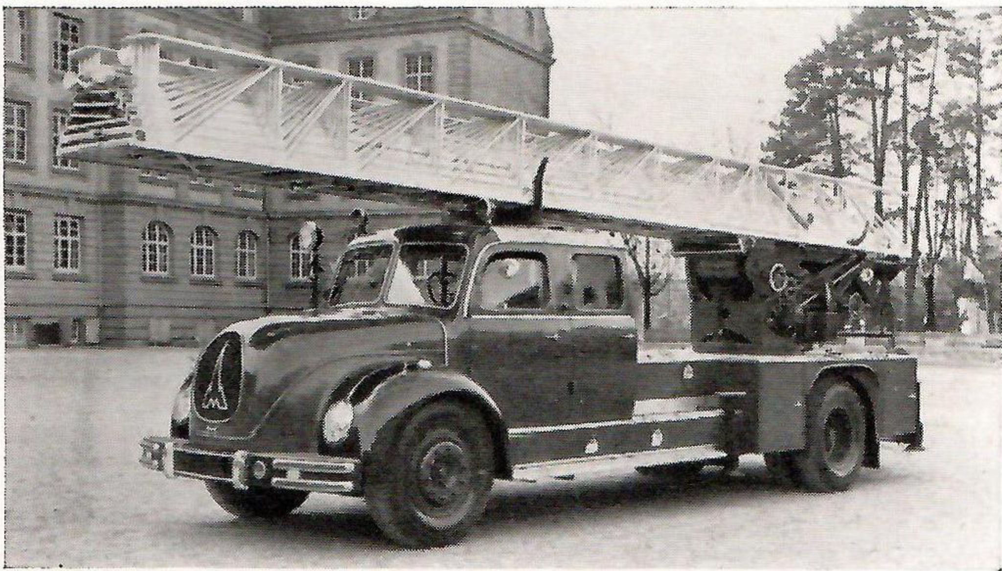
Bild 19 Kraftfahrdrehleiter 52 + 2 m, höchste Leiter der Welt
