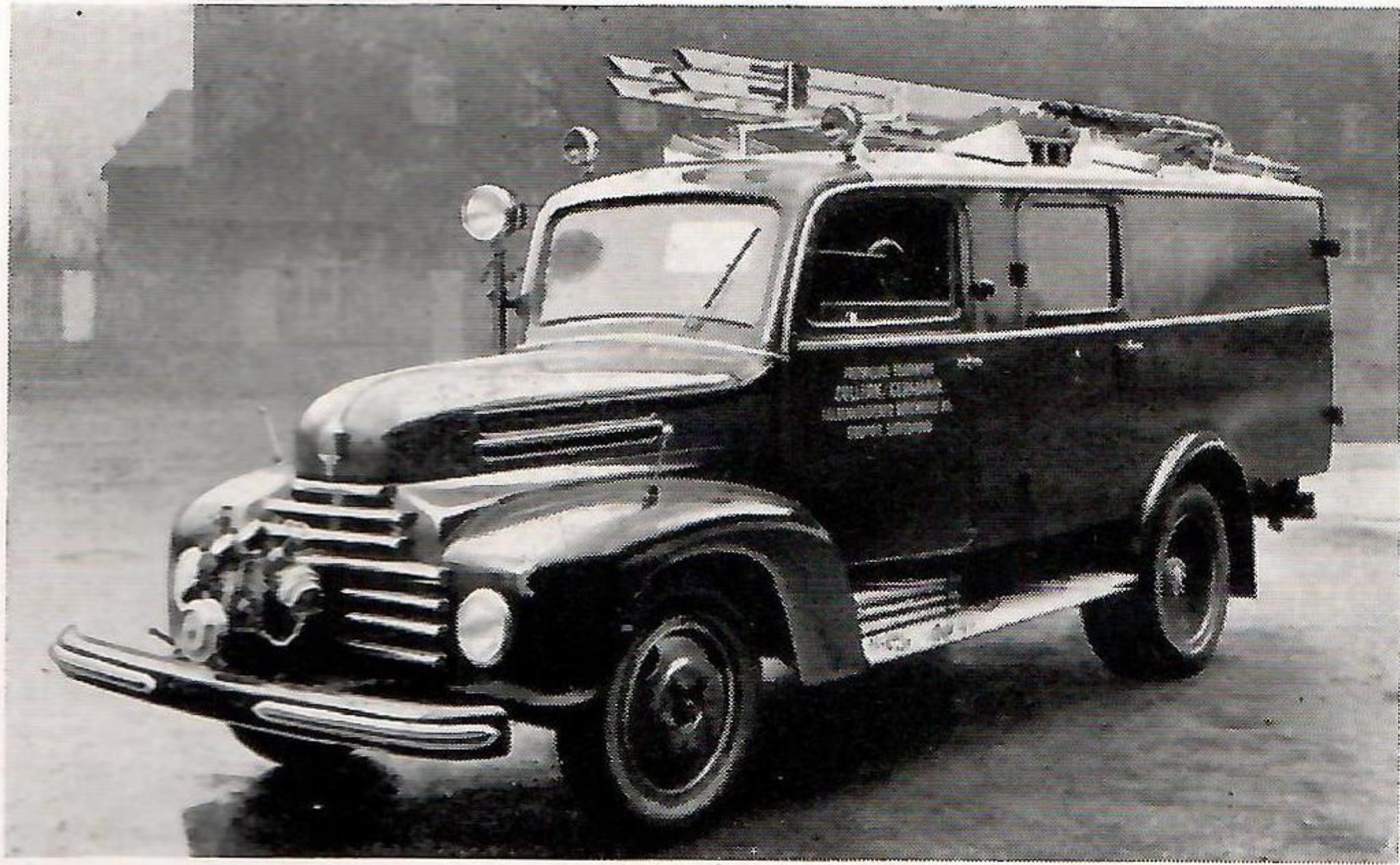
Bild 97 Löschgruppenfahrzeug LF 8 mit Vorbaupumpe
