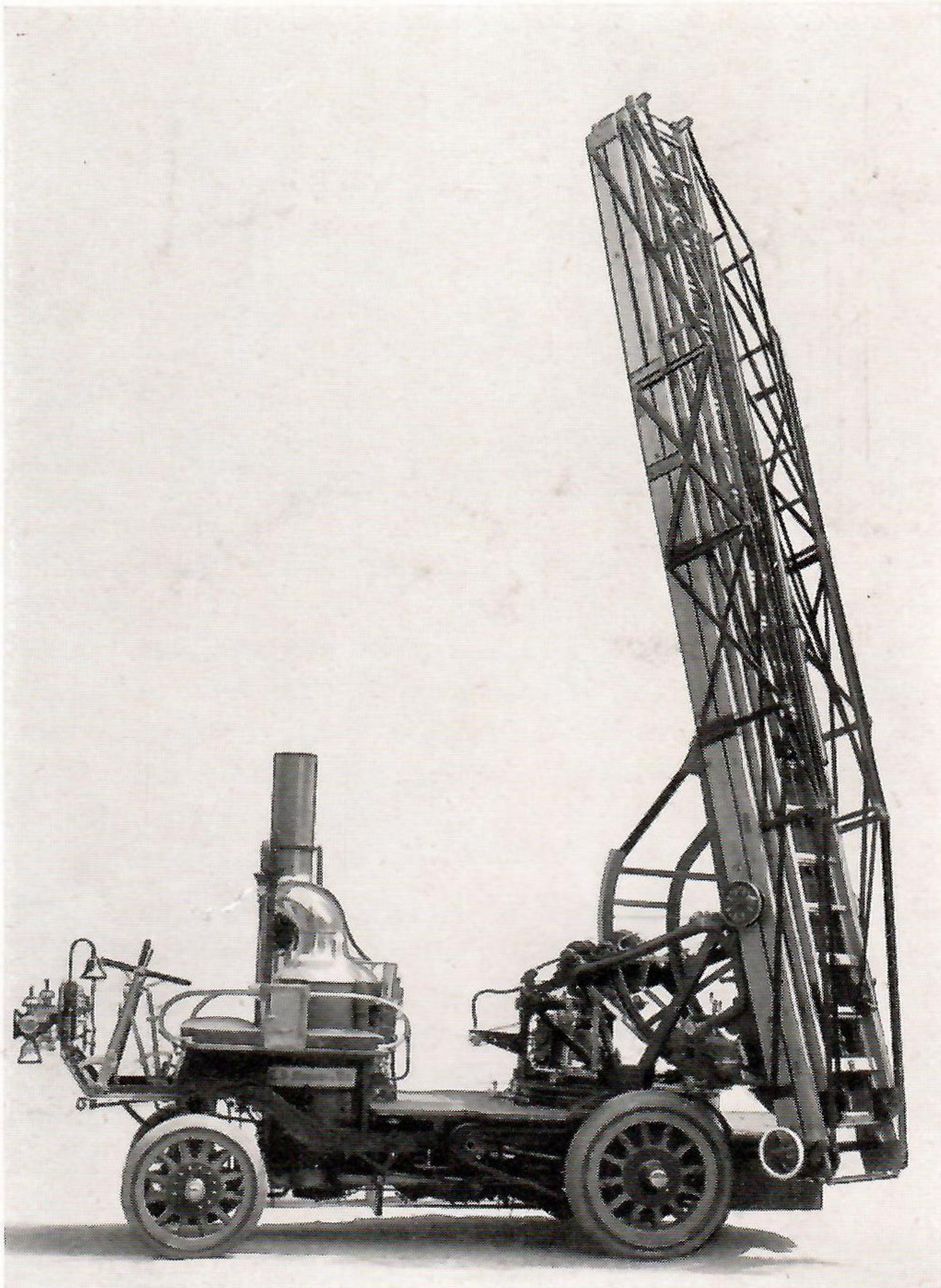
Bild 14 Erste Kraftfahr-Drehleiter mit Dampfantrieb (1904)
