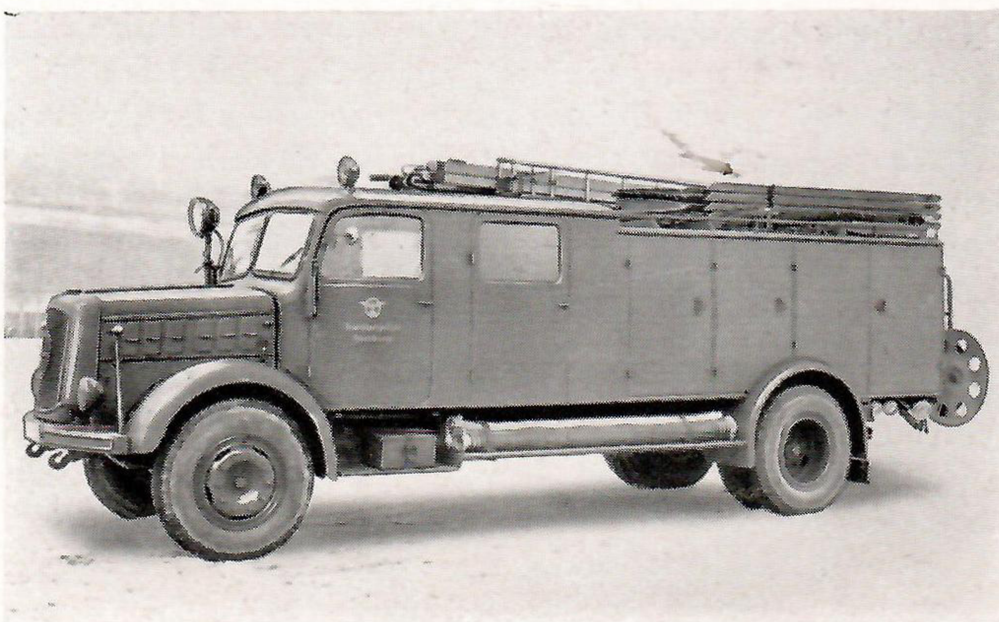
Bild 32 Löschgruppenfahrzeug in geschlossener Bauform, 1942
