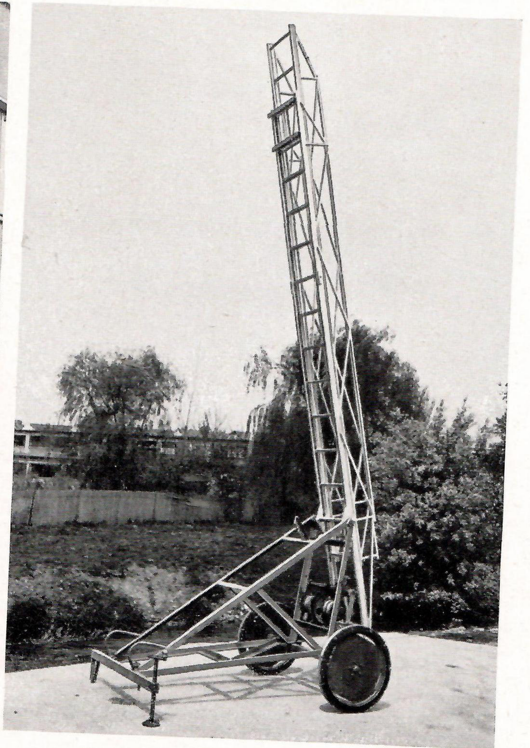
Bild 72 Anhängelleiter, Bauart ALS 10, 10 m Steighöhe
