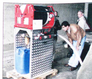
Die getestete Tunnelnischen-Löschanlage.
