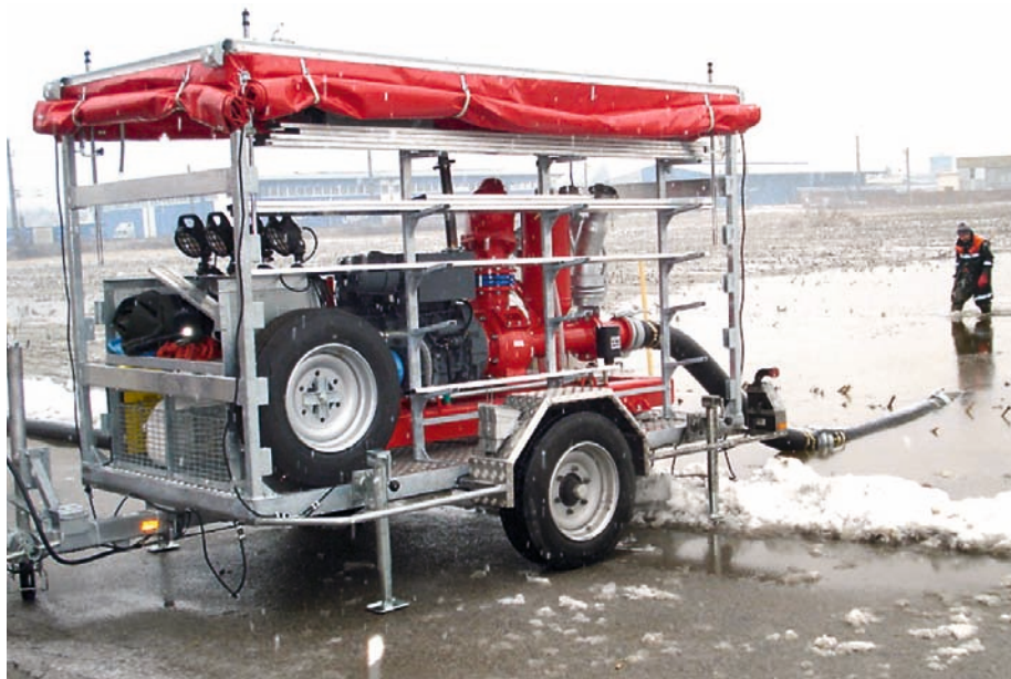
Jede der acht neuen Großpumpen, die vom Landes-Feuerwehrverband angeschafft wurden, liefert eine Leistung von 6.000 Liter pro Minute.
