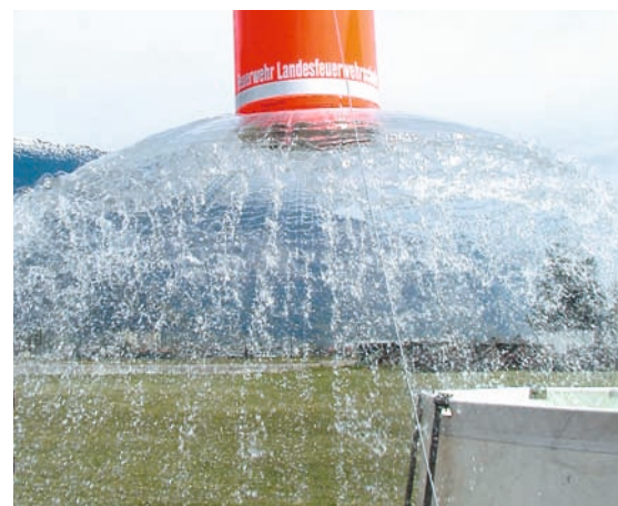
Der Semat-Behälter im Einsatz. Damit können entweder Flächen bewässert oder Punktabwürfe gemacht werden
