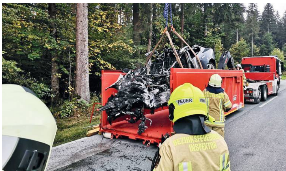
Der Abrollcontainer wurde erstmals bei einem Brand eines Elektroautos eingesetzt.
