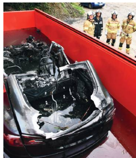
Das Wrack wurde geflutet und die Batterie, so wie in solchen Fällen vorgesehen, gekühlt.
