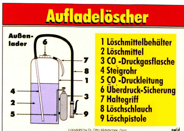
Abb. 3 und 4: Schematische Darstellung des Aufbaues von Auflade- und Dauerdrucklöschern
