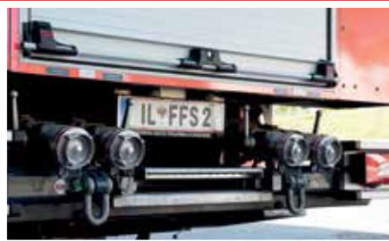
Vier Eingänge sorgen für eine ausreichende Wasserzufuhr im Einsatzfall.
