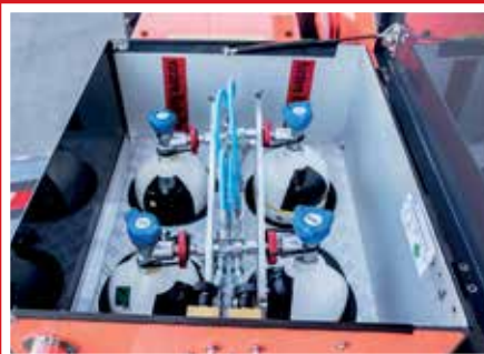
Über ein ausgeklügeltes Luft-leitungssystem können bis zu vier Personen im Korb gleichzeitig mit Luft aus Pressluftflaschen versorgt werden.
