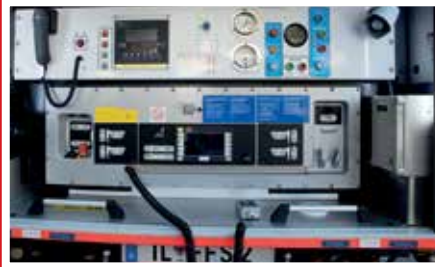
Das Herz der Maschine im Heck. Die Pumpensteuerung, Schaum-zumischung und Abstützung
