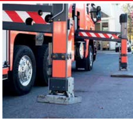
Bis zu 17 t können auf eine einzelne Abstützung wirken. Für die optimale Abstüt-zung wird der Fahrer durch ein Bluepoint-system unterstützt, welches dem Fahrer die endgültige Stützenposition anzeigt.
