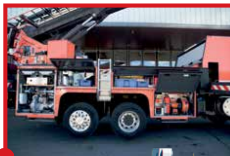
Die Einbaupumpe, ein Hygieneboard sowie Beleuchtungs- und Absperrmaterial finden sich auf der rechten Fahrzeugseite.
