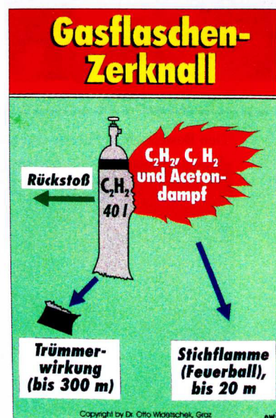
Sprengung einer Acetylen-gasflasche.
