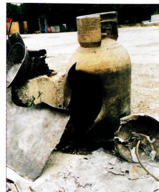
Zerknallte Gasflaschen nach Brandeinwirkung. (Foto. Kabelka)
