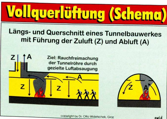
Mit einer Vollquerlüftung soll der Tunnel rauchfrei gehalten werden.
