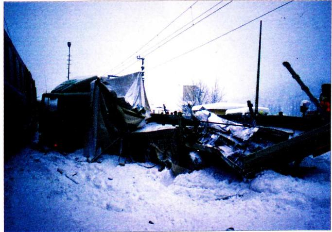
**Auf der Zuglokomotive kamen noch Teile des Satellitenaufhängers zum Liegen. Die Entfernung dieser Teile konnte erst nach der Abschaltung und Erdung der Fahrleitung erfolgen.**
