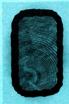
Nach einer Brandeinwirkungsdauer von 60 Minuten reduziert sich die Abmessung auf ca. 24 x 10 cm! Ist die statische Bemessung ausreichend, kommt es zu keinem Versagen der Konstruktion – die Dachkonstruktion stürzt nicht ein.
