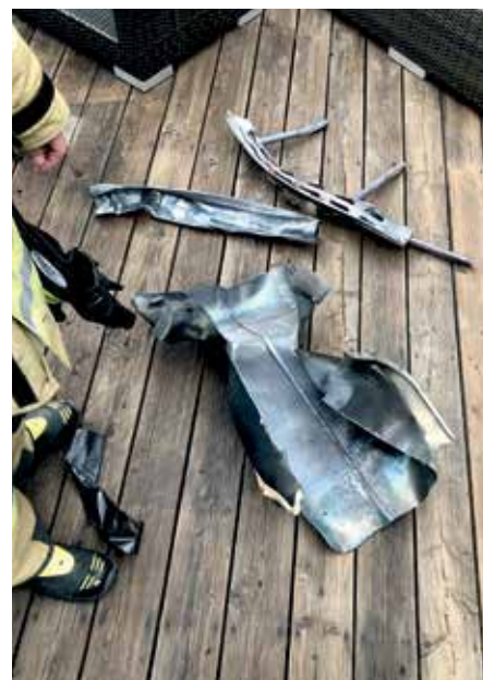
Die Trümmer der Gasflasche waren im Umkreis von 15 bis 20 m zu finden.
