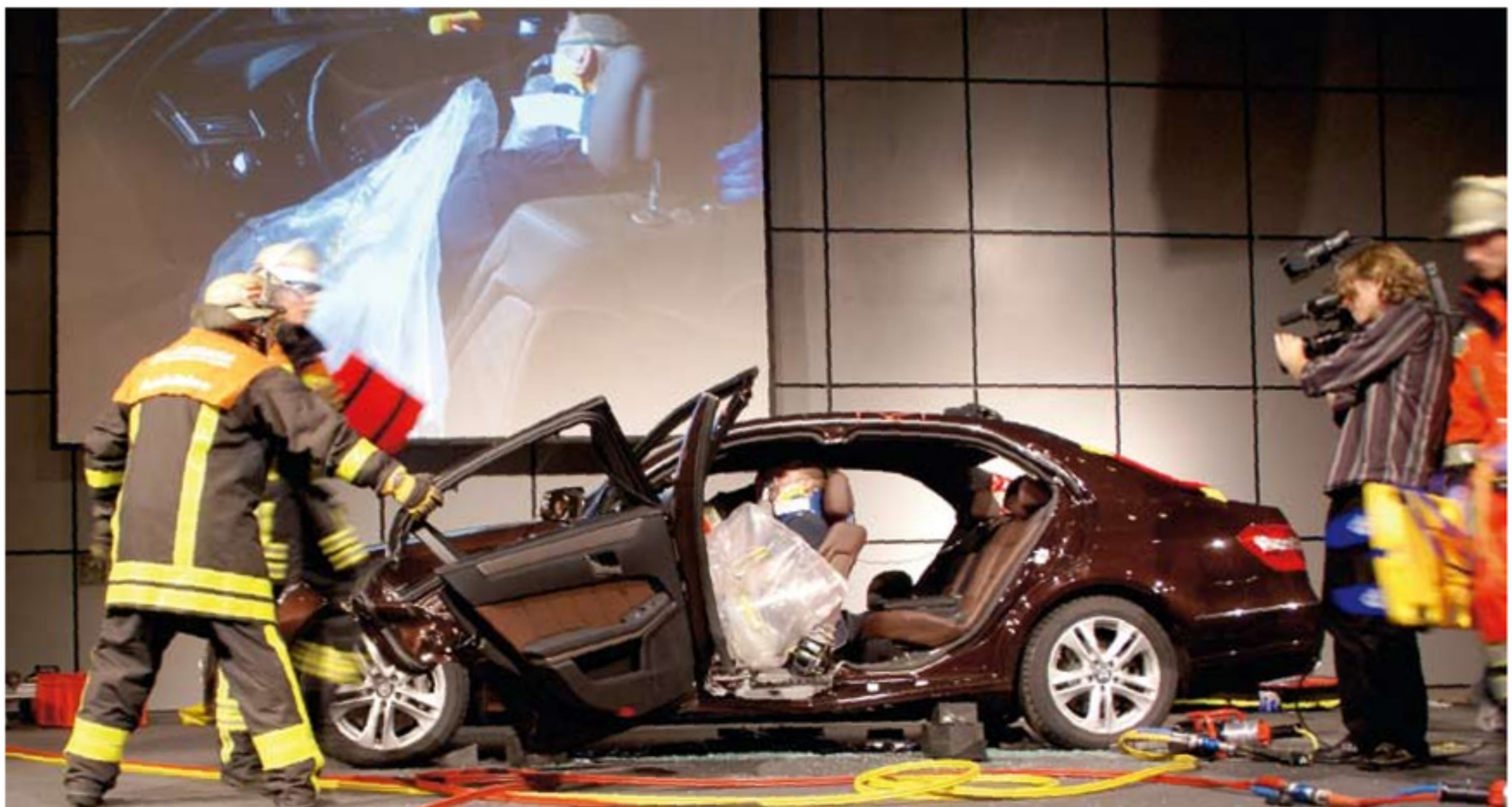
Auf der IAA in Frankfurt – bei der auch die Rettungskarte präsentiert wurde – ging es nicht nur um Theorie (Foto oben), sondern auch um die Praxis. Dazu wurde ein nagelneues Fahrzeug von den Teilnehmern nach einem angenommenen Crash von Feuerwehrmännern anhand der Informationen der Rettungskarte aufgeschnitten und jeder Schritt für das Publikum mittels Großbildleinwand übertragen.
