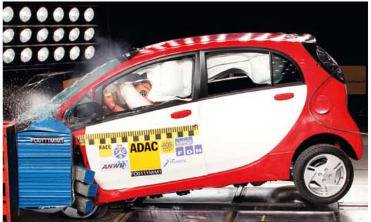
Der Crashtest liefert den Beweis, dass für Insassen und für Retter keine Gefahr durch die Fahrzeugbatterien besteht – über den Platz für die Rettungskarte wird noch gesprochen!
