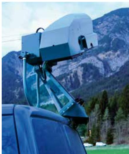
**Das ist die „Eule“** – eine auf einem Spezialfahrzeug montierte Wärmebildkamera!
