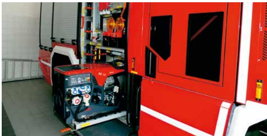
Alle Löschfahrzeuge der Tiroler Feuerwehren sind mit eigenen Stromaggregaten ausgerüstet, so auch dieses RLFA 2000/100.
