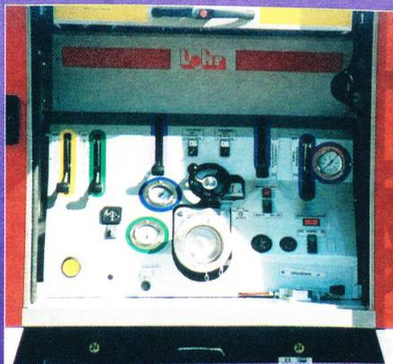
Der zweistufige Normaldruck und der einstufige Hochdruck sind auf einer gemeinsamen Pumpenwelle angeordnet, was für extreme Laufruhe sorgt. Für weiteren Bedienungskomfort sorgen der ergonomisch gestaltete Pumpenbedienstand sowie die vollautomatische Entlüftungseinrichtung Magirus-Prmatic. Die selbsttätig nachstellende Axial-Gleitringdichtung macht die Magirus-Pumpe außerdem weitgehend wartungsfrei. Doch am besten, Sie überzeugen sich selbst – wir freuen uns auf Ihren Anruf und Besuch.
