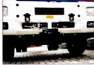
Durch diese Einbauvariante steht die Seilwinde (siehe Foto) weder nach vorne vor, noch vermindert diese die Bodenfreiheit des Fahrzeuges. Die zusätzlich zur Seilwinde eingebaute SEILSPULVORRICHTUNG verhindert einseitiges Aufrollen oder Scheuern des Seiles an der Trommelwand, wodurch auch optimal seitlich zugezogen werden kann und die Lebensdauer des Seiles beträchtlich erhöht wird.
