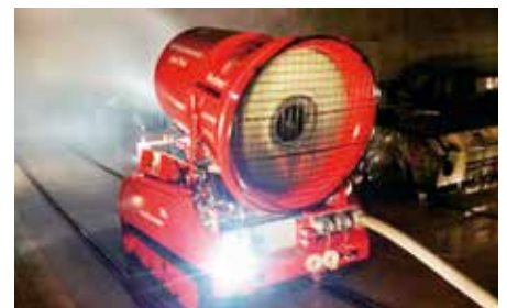
LUF-Einsatz beim Brand in der Tunnelröhre
