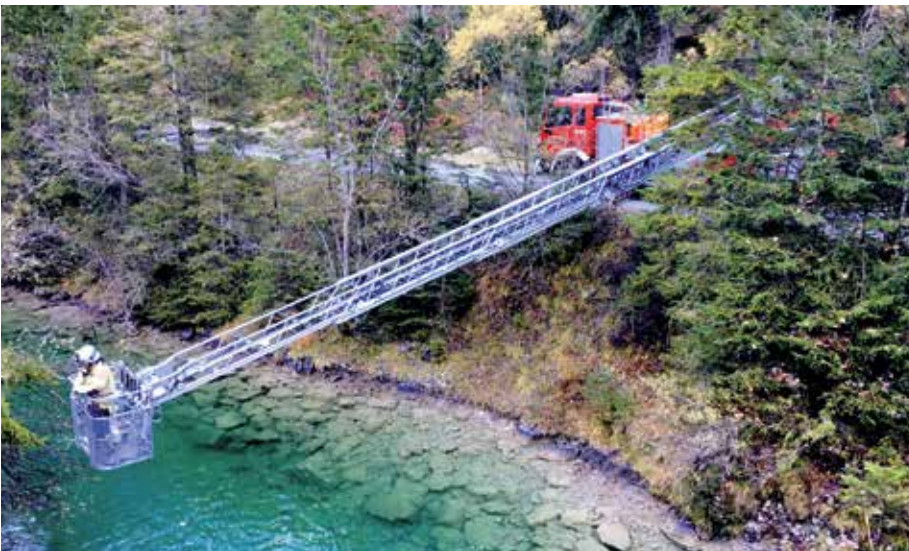
Mittels Drehleiter geht es nicht immer steil hinauf, sondern manchmal auch hinunter.
